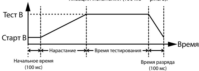
Рис. 3. Временная диаграмма включения и снятия U_{\text{тест}}
